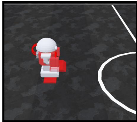
그림 45 축구 로봇 슬라이더 : 발 아래의 빨간색 부분은 하단 슬라이더에 해당한다. 발 앞쪽의 빨간 부분은 전면 슬라이더에 해당한다.
